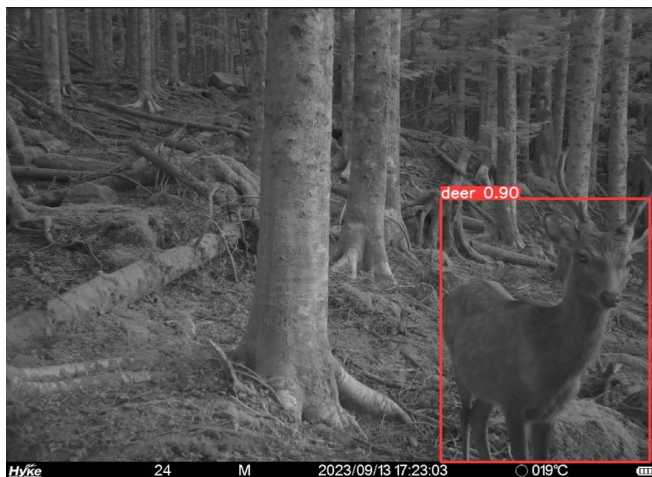
図1. IoT自動撮影カメラにて撮影されたシカ(オス)と物体検出モデルYOLOv8による検出結果.
